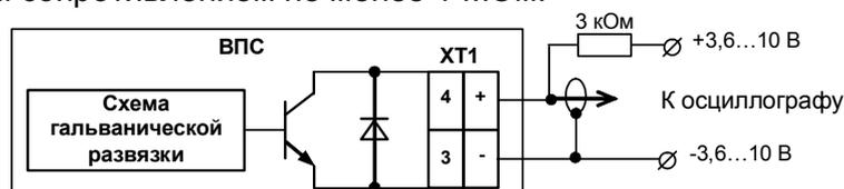
Следует помнить, что при контроле сигналов на выходах, выполненных по схеме «открытый» коллектор (ОК), в случае отсутствия вторичного прибора, необходимо соединить минус дополнительного источника питания (3...10 В) с эмиттером выходного транзистора, а его коллектор - с плюсом источника питания через резистор сопротивлением не менее 3 кОм.
