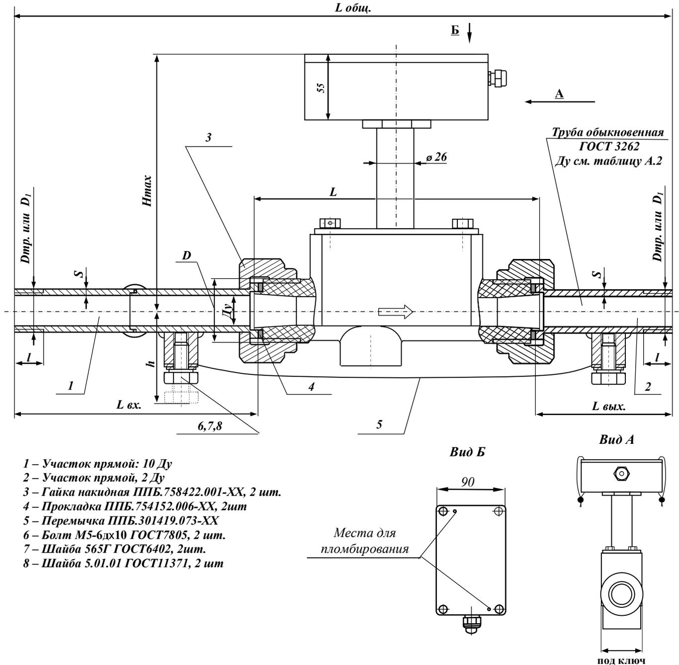
Рисунок А.1 – Габаритные и присоединительные размеры преобразователей
