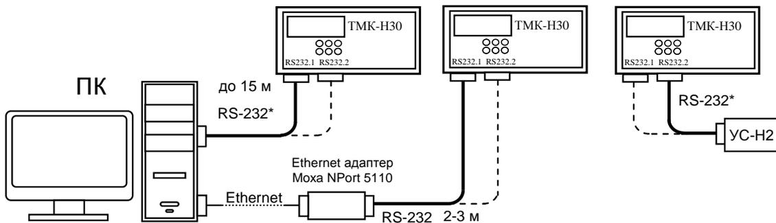
Подключение сети из ТМК к ПК через конвертер RS232/RS485 или Ethernet адаптер
