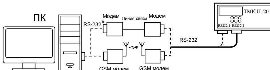
Подключение сети из ТМК к ПК с использованием адаптера модема (АМ-02) по интерфейсу RS485 через проводную или беспроводную линии связи
