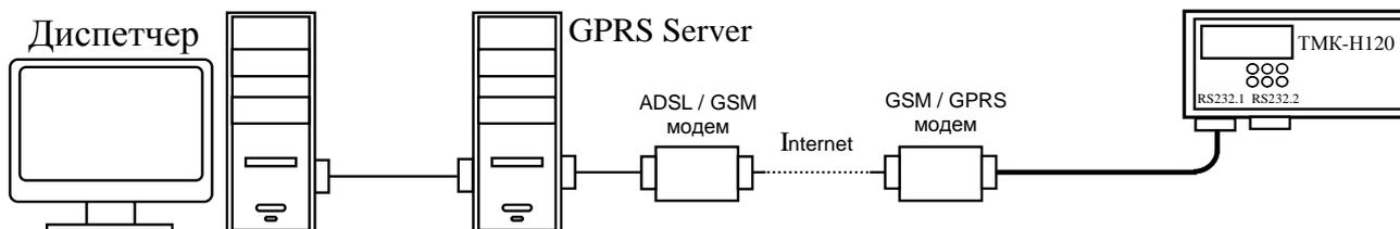
\*- подключение к ПК через интерфейс RS-232 (COM-порт) или через интерфейс USB (USB-порт)
