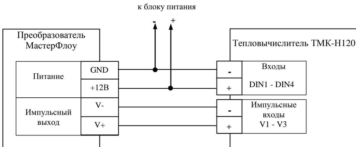
Пример подключения преобразователя МастерФлоу с импульсным выходом к ТМК-Н120 с обеспечением контроля напряжения питания
