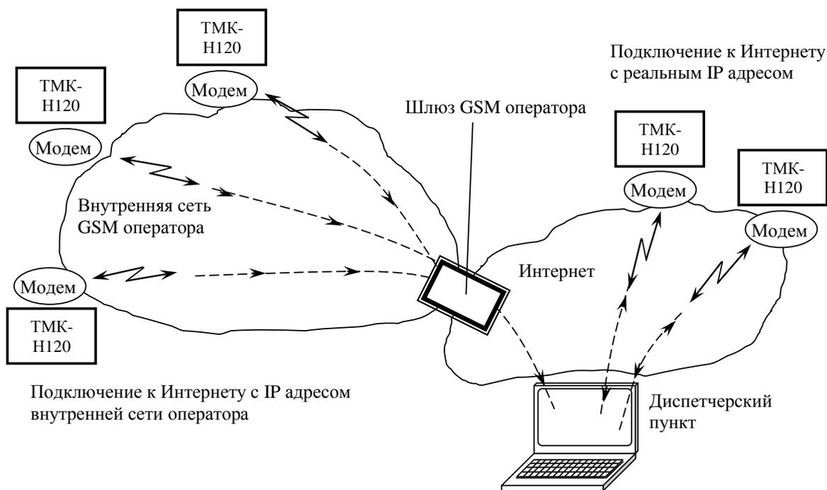
Связь через GPRS канал осуществляется через сеть Интернет. Инициатором обмена служит вычислитель. Основанием начала установки связи могут быть следующие события:
