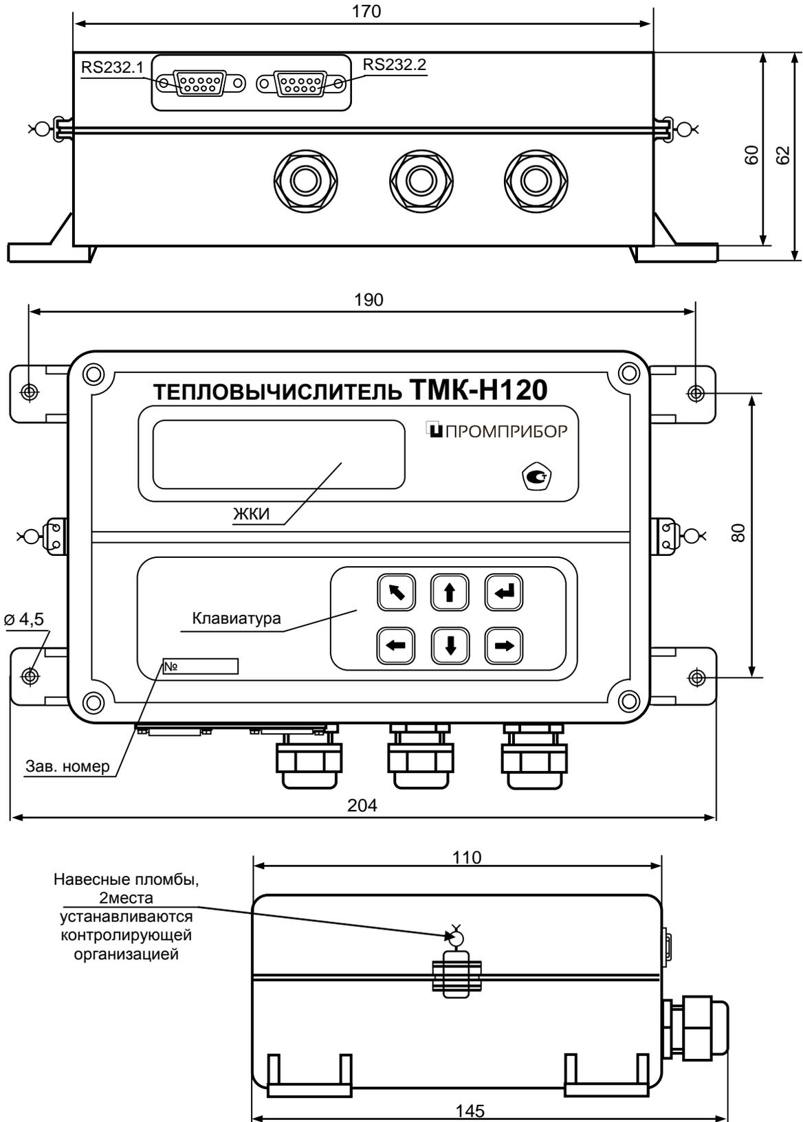
Примечание - Неиспользуемые разъемы интерфейсов RS232.1 и RS232.2, а также кабельные вводы должны быть закрыты штатными заглушками (на рисунке не показано).
