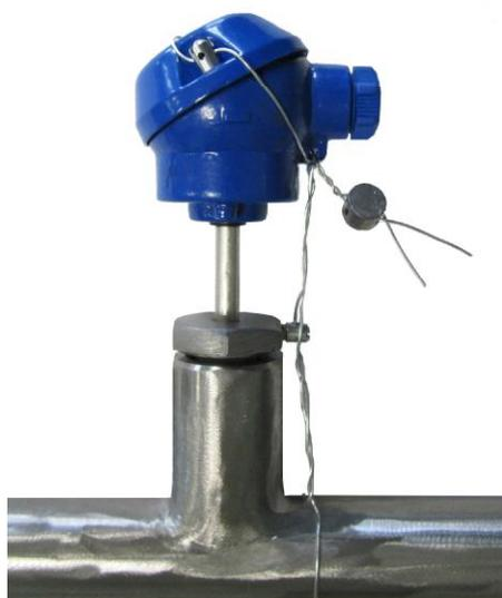
Рисунок 5 - Схема пломбировки ТС (головка
